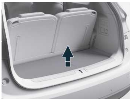
Иллюстрация: подъем фальшпола багажника
