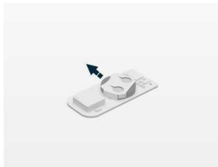
Иллюстрация: извлечение батарейки
