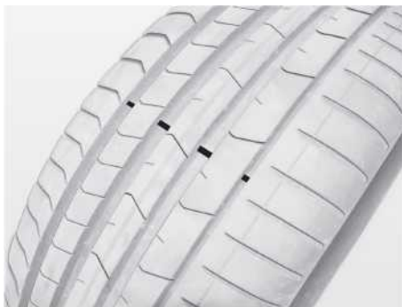
Иллюстрация: признаки износа протектора
