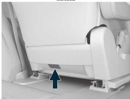
Иллюстрация: крепления с верхней страховочной лямкой
