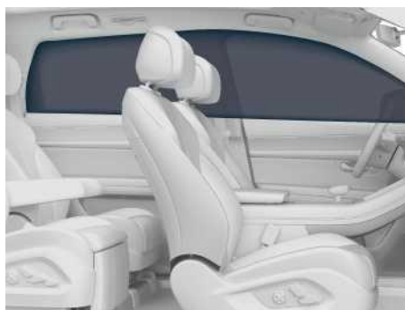
Иллюстрация: срабатывание шторок безопасности
