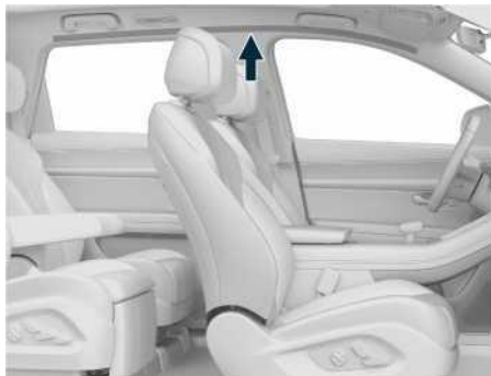
Иллюстрация: расположение шторок безопасности
