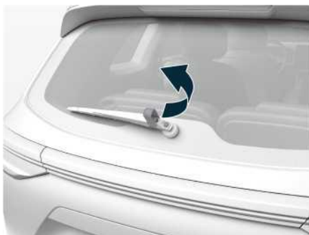
Иллюстрация: замена щеток заднего стеклоочистителя
