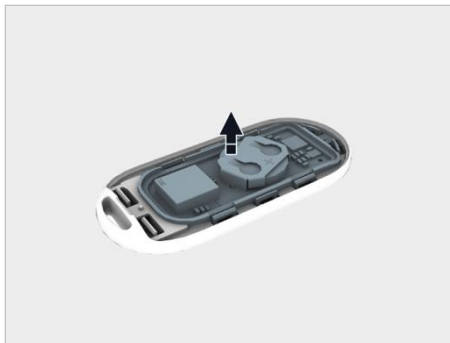
Иллюстрация: снятие печатной платы ключа дистанционного управления
